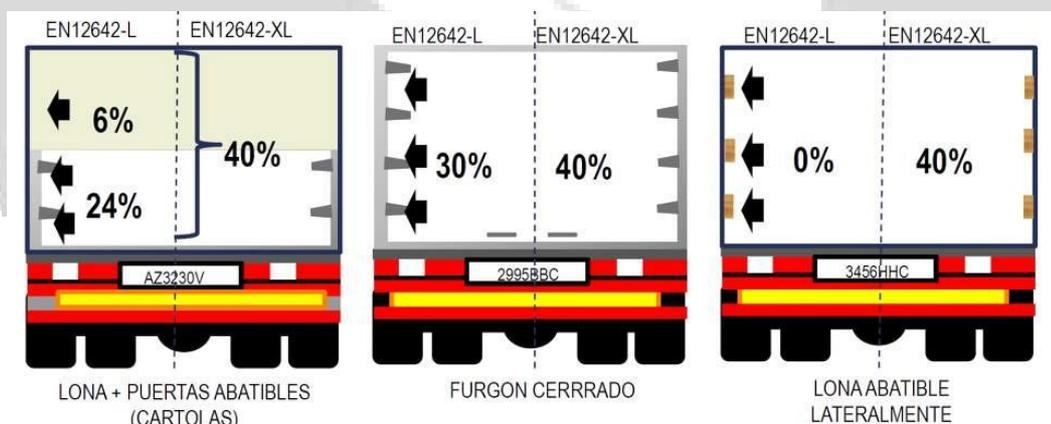
Porcentaje de carga útil que deben resistir el testero y las puertas traseras.
