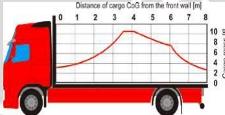
Estos vehículos pueden estar equipados con diagramas especiales, que indican la carga ÚTIL admisible en función de la posición longitudinal de su centro de gravedad.
